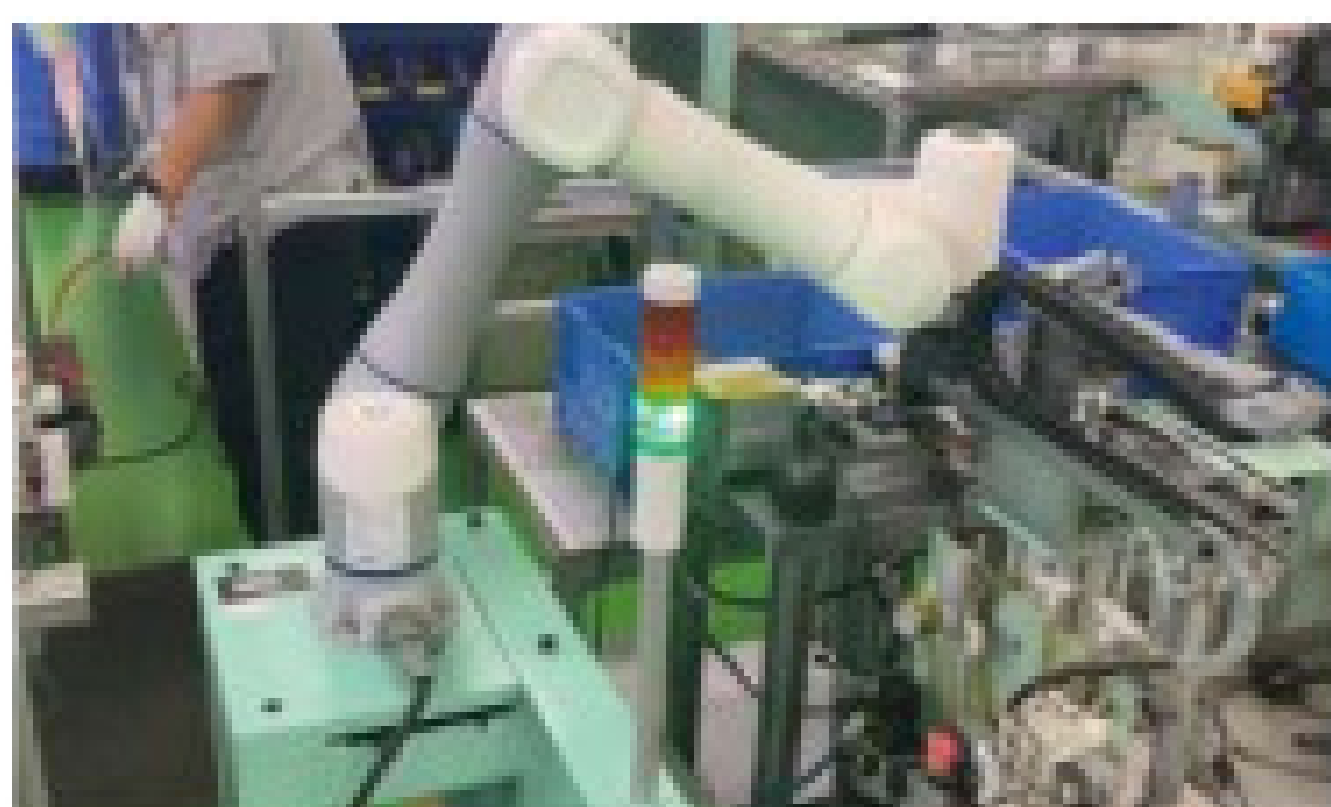
Instalación de juntas de tuberías de aceite para automóviles
