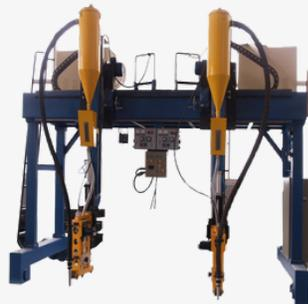
Sistema Gantry Puentes para soldadura longitudinal
