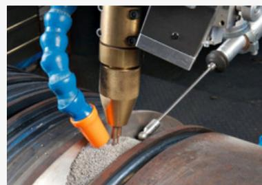
Soldadura por arco sumergido (SAW)
