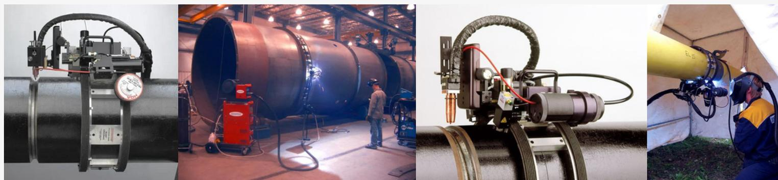
**Soldadura orbital con proceso MIG para tendidos de línea:** máquina de alta velocidad y gran depósito de soldadura, perfecta para soldaduras repetitivas en campo tal como tendidos de línea.
