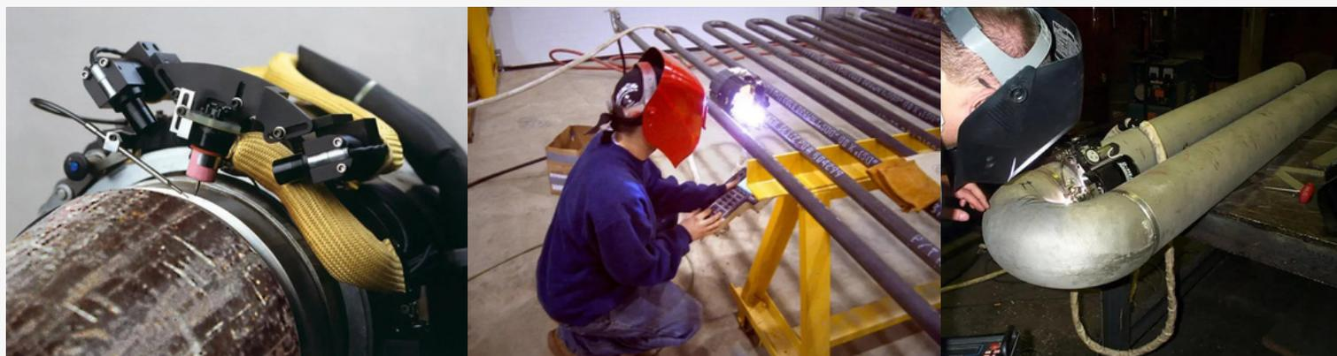
**Soldadura orbital con proceso TIG:** Totalmente automática, especial para soldadura de aleaciones especiales, o donde se requiera una excelente calidad como en refinerías.
