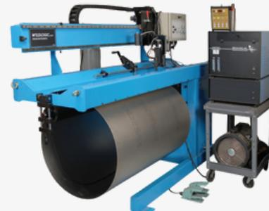
Sistema Seam Welder Soldadura longitudinal de tuberías
